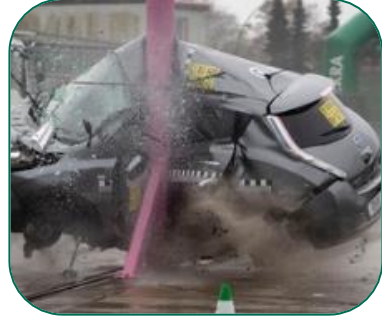
Gesamtfahrzeugcrash von Elektrofahrzeugen (DEKRA Crash Test Center Neumünster)
