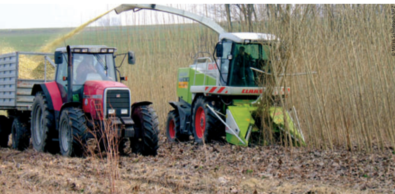
Pappel-Ernte in einer Kurzumtriebsplantage: Nach drei Jahren Dauerkultur werden die Baumstämme abgeschnitten und zerknüllt.
