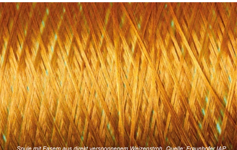
Spule mit Fasern aus direkt versponnenem Weizenstroh. Quelle: Fraunhofer IAP
