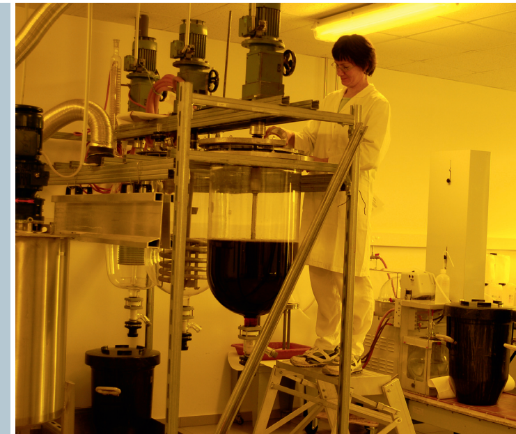
Herstellung eines kommerziellen Fotoresists unter Gelblicht
